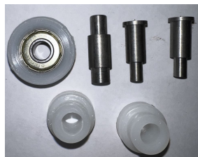
R-722 KANGOO - reparacion porton rodillo lateral
